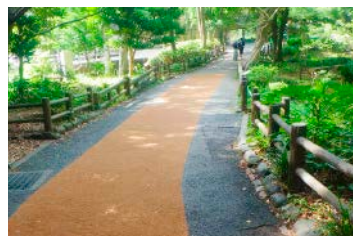
ジャイアントパンダの食べ残したタケを利用した園内舗装(恩賜上野動物園)
